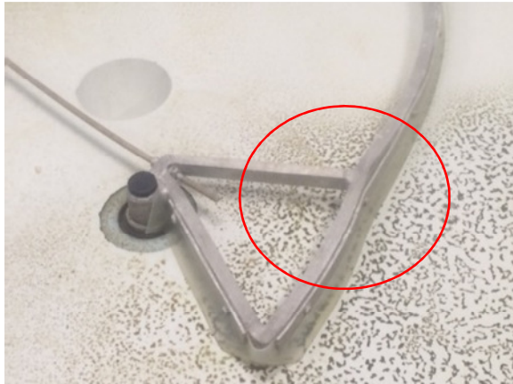
Figuur 5 Knik net na de eerste dwarsverbinding in roterende schraaparmen
