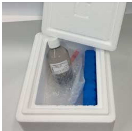
Figuur 9 en 10: Links de polystyreen box met koelelementen; Rechts steriel zeewater in een fles voor optimale conservering eitjes
